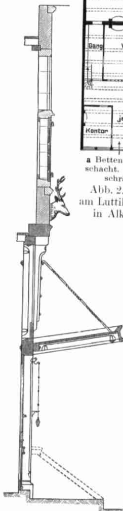
Abb. 4. Schnitt durch die Frontmauer.
