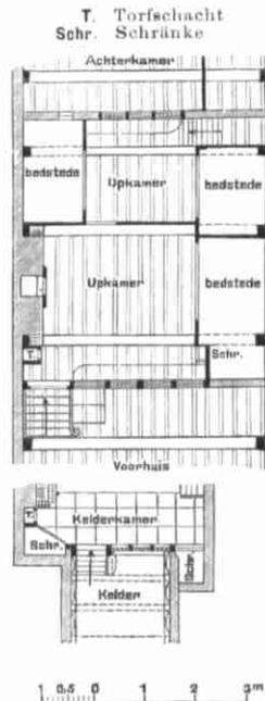
Abb. 8. Erdgeschoß in Höhe der Upkamer und Keldergeschoß.
