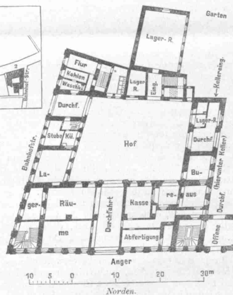
Abb. 2. Hauptsteueramt in Erfurt. Erdgeschoss.
