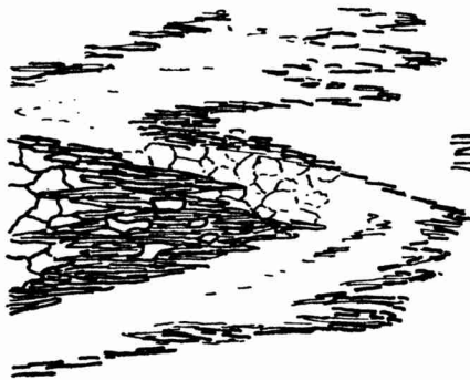
Abb. 33. Aus chloritreichem Serizitphyllit Nr. 11. Schoppfältchen aus Chlorit in Quarzgewebe. Kräftig ausgezogen: Chlorit, körnig: Quarz. Querschnitt. Vergr. 65 lin.
