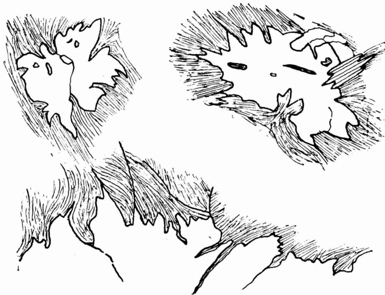
Abb. 42. Aus den Pennin-Porphyroblasten-Phylliten Nr. 108—112. Beispiele belteroporen Wachstums von Pennin-Basisschnitten im zerscherten Serizitgewebe (fein langstrichlig gezeichnet, den Lamellenlagen entsprechend). Ein größerer Porphyroblast am Schliffrand ist nur z. T. erhalten, zeigt aber besonders schön das Wachsen nach der Wegsamkeit in den Serizitpaketen und das zapfenförmige Eindringen nach Scherflächen. Querschnitt. Vergr. etwa 60 lin.
