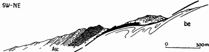
Abb. 9. Die Liguriden-Überschiebung bei S. Margherita di Bobbio.
