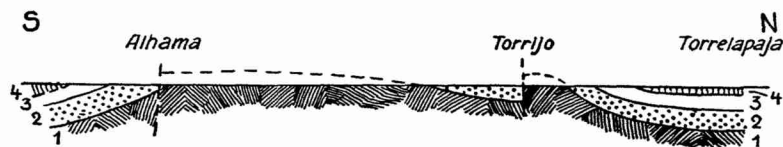
Abb. 15. Profil durch die Schwelle von Ateca. Die Horizontale stellt die Transgressionsfläche des Oberalb dar (vgl. die Profillinie der Abb. 14!). 1 Paläozoikum, 2 Trias, 3 Rät, 4 Jura. 1:500000. 4 fach überhöht.
