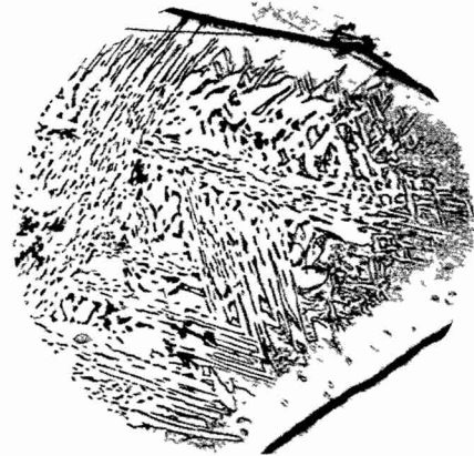
Fig. 14. Derselbe Plessit wie in Fig. 13. Beteiligung des Phosphides am Aufbau des Plessit, nach- gewiesen durch Na-Pikratätzung. 70\times vergr.
