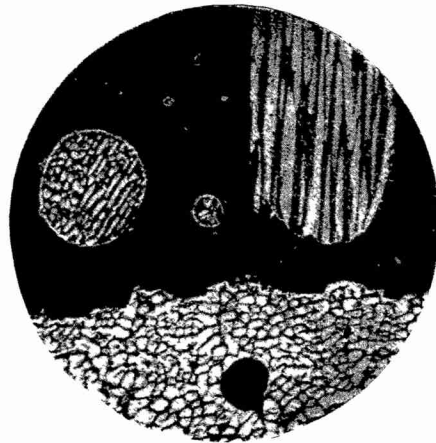
Fig. 16. Quaternäre Legierung (73 % Fe, 15 % S, 7 % P, 5 % Ni) mit sulfidischer und phos- phidischer Schicht und entspr. Tropfen (hell Schreibersit, dunkel Troilit). \text{HNO}_3 -Ätzung. 70\times vergr.
