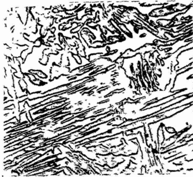
Fig. 5. Legierung mit 2% Ni und 0,7% P 12 St. auf 630° erhitzt, vorher im \alpha -Raum homogenisiert. \gamma -Nadeln, U-Figuren I. Art. Geätzt mit alkohol. Pikrinsäure. 70 \times vergr.
