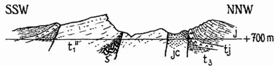
Abb. 7. Profil durch das Ostende der nordbewegten monoklinalen Talayuelas-Achse nördlich Sinarcas. Von [26,0; 135,5] nach [27,5; 139,5].
