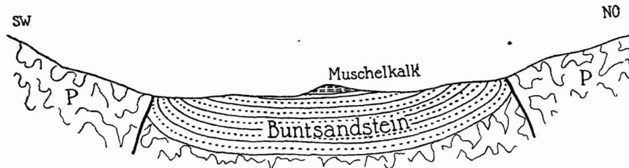
Fig. 3. Schematisches Profil durch das Senkungsfeld von El Frasno zwischen Calatayud und La Almunia (Iberische Ketten) ohne Maßstab.
